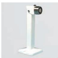
Electroimán retenedor de puertas universal para montaje en techo, pared o suelo. 500N de fuerza. Cabeza ajustable y estructura robusta de acero de 250 mm de longitud, pudiendo acortarse fácilmente. Pulsador de desbloqueo y contra-placa con rótula. Fusible de protección. 24 V 45mA.
