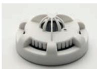
Detector de **temperatura** de tecnología analógica y direccionamiento individual. Específico para detección en ambientes donde no puedan emplazarse detectores de humo o donde sean previsibles fuegos que cursen sin humos o con elevada emisión de calor. Control de sensibilidad desde la central. Led indicador de estado y salida para piloto remoto. Diámetro: 100 mm. Certificado EN 54-5. **Base no incluida.**
