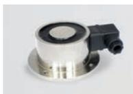
Electroimán retenedor con protección ambiental IP-65 y entrada de cables sellada. Construcción robusta en acero cincado para aplicaciones especiales incluso exteriores y marítimas. 1.200 N de fuerza. 102 (diámetro) x 45 mm. Incluye contra-placa y rótula. 24V 7W.
