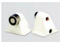
Electroimán retenedor de puertas de fijación a suelo, con pulsador de desbloqueo y contra-placa con rótula, 200 N de fuerza. Caja aluminio de gran robustez.. Fusible de protección. 24 V 45 mA. Medidas 110 x 80 x 95 mm.
