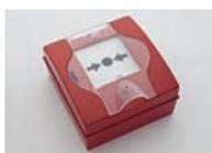
Pulsador de alarma de direccionamiento individual y **aislador de cortocircuitos incorporado**. Disparo manual rearmable. Incluye tapa transparente de protección. Posibilidad de montaje semi-empotrado. Led indicador de estado. Medidas: 105 x 100 x 60 mm. Certificado EN54-11
