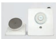
Electroimán retenedor de puertas de fijación a pared, con pulsador de desbloqueo y contra-placa con rótula, 200 N de fuerza. Caja plástico ABS piro-retardante. Fusible de protección. 24 V 45 mA. Medidas 95 x 85 x 45 mm.
