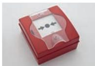
Pulsador de alarma **rearmable** color rojo. Incluye **tapa de protección y diodo zenner** (permite su identificación por la central). Diseñado para montaje en superficie o empotrado y gran facilidad para conexión y mantenimiento. Rotulado pictogramas estándar. Incluye llave de reposición. Medidas: 110 x 105 x 63 mm. **Certificado EN 54-11-2001.**
