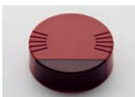
Sirena de alarma interior con destellante de **muy bajo consumo: 12 mA** 15-30 V. 90 db. Selector de tonos. Función anti-pánico inicial. Entradas para cable empotrado o bajo tubo visto. Medidas: 100 x 35 mm. Color rojo. **Certificada EN 54-3-2001.**
