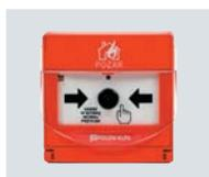
Pulsador de alarma para interior vía radio. Disparo manual **rearmable**. Comunicación supervisada con receptor ACR-4001 en frecuencia 868 – 870 MHz. Alimentado mediante 2 pilas CR123 (hasta 3 años de duración). Direccionamiento individual. Incluye tapa transparente de protección y led indicador de estado. Medidas: 102 x 98 x 46 mm. Certificado EN54-11 y EN54-25
