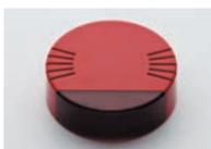
Sirena de alarma **interior** con destellante de direccionamiento individual y alimentación directa del bucle. **Aislador de cortocircuitos incorporado.** Selector de tonos. Función anti-pánico inicial. Entradas para cable empotrado o bajo tubo visto. Medidas: 100 x 35 mm. Color rojo. Certificada EN-54 3-2001.
