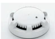
Detector **óptico de humos** de tecnología analógica y direccionamiento individual. Específico para detección con carácter general mediante el análisis de humos de combustión en cámara óptica. Control de sensibilidad y corrección de contaminación desde la central. Led indicador de estado y salida para piloto remoto. Diámetro: 100 mm. Certificado EN54-7. **Base no incluida.**
