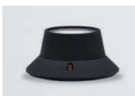
**Detector óptico de llamas** por detección de radiación ultravioleta en la longitud de onda de 200 nm. mediante electrodo colector en tubo de gas. Uso en interiores. Hasta 17 m. de alcance y 120 ° de apertura. Led indicador de estado y salida para piloto remoto. Alimentación 17-24 Vcc, 20 mA en alarma. **Base mod. G-33 no incluida.** Diámetro 110 mm. **Certificado** CNBOP 1987 -2005.
