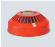
Sirena de alarma para interior direccionable con **aislador de cortocircuitos incorporado**. Led indicador de estado y avería. Zumbador piezoeléctrico. Potencia acústica alimentada del bucle: **85 dB**. Permite incrementar la potencia a **94 dB** añadiendo una pila de 9V, o a **100 dB** añadiendo alimentación externa (24Vcc). Medidas 115 x 54 mm. Incluye base de conexión resistente al fuego G-40S. Certificado EN54-3
