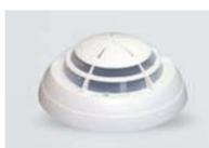
**Detector óptico de humos autónomo** para aplicaciones domésticas o similares, dispone de una alarma audible de 85 db, pulsador de prueba y led de supervisión e indicación de estado y avería. Alimentación mediante pila alcalina de 9V con duración superior a dos años (**Incluida**). Posibilidad de interconexión en red entre varios detectores para mejor transmisión de la alarma. Fácil limpieza de mantenimiento de la cámara de detección. Certificado EN14604:2005 – Nº: 1438/CPD/0145
