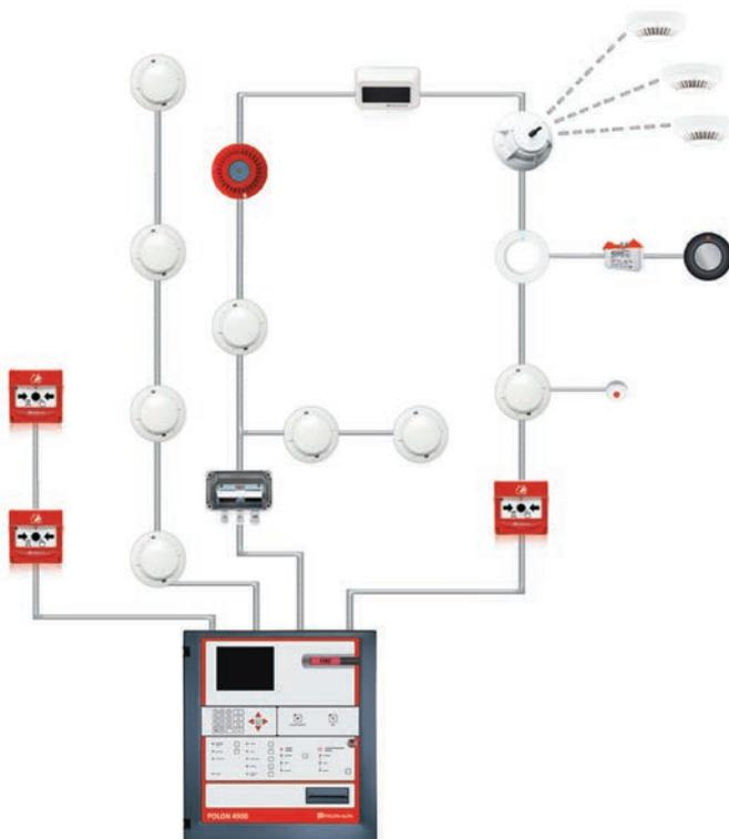
El sistema Polon 4000 cubre un amplio abanico de instalaciones de detección y alarma de incendios, que van desde edificios de pequeño tamaño a grandes complejos que requieren de varios sistemas conectados en red con capacidad hasta un total de 31.000 dispositivos direccionables.
