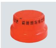
Sirena de alarma para interior direccionable con **aislador de cortocircuitos incorporado**. Led indicador de estado y avería. Zumbador piezoeléctrico con **16 tonos** seleccionables.. Potencia acústica alimentada del bucle: **85 dB**. Permite incrementar la potencia a **94 dB** añadiendo una pila de 9V, o a **104 dB** añadiendo alimentación externa (24Vcc). Medidas 115 x 70 mm. Incluye base de conexión resistente al fuego G-40S. Certificado EN54-3
