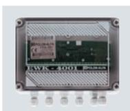
Módulo direccionable de 8 entradas independientes. Conexión directa al bucle y **aislador de cortocircuitos incorporado**. Permite la monitorización (alarma o señal técnica) de dispositivos externos asociados al sistema. Selección de señales NA o NC independientes para cada entrada, con indicación individual en la central. Led indicador de estado. **Incluye caja IP-65**. Medidas 175 x 146 x 75 mm. Certificado EN54-18.
