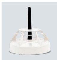
El **adaptador vía radio** ACR 4001 permite el enlace de hasta 16 detectores ópticos vía radio como una línea derivada de detectores conectados al bucle, y pudiendo reconocer cada uno éstos como unidades independientes con su propia dirección. Frecuencia 868 - 870MHz. Alcance en campo abierto: 100 metros. **Aislador de cortocircuitos**. Antena integrada. Medidas 115 x 133 mm. **Incluye base de conexión G-40**. Certificado EN54-18 y EN54-25
