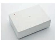
Modulo de **entrada en formato estándar 4-20 mA**. Conexión directa al bucle y aislador de cortocircuitos incorporado. Permite la conexión al sistema de dispositivos externos que trabajen en este formato (sondas de medición de gases, niveles, presión, etc.) Led indicador de estado. Medidas: 154 x 109 x 50 mm.
