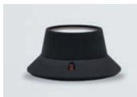
**Detector óptico de llamas intrínsecamente seguro** por detección de radiación ultravioleta similar al modelo PUO35, para aplicación en zonas potencialmente explosivas. Uso en interiores. Hasta 17 m. de alcance y 120 ° de apertura. Led indicador de estado y salida para piloto remoto. Alimentación 17 – 24 Vcc, 20 mA en alarma. **Base modelo G-33 no incluida.** Diámetro 110 mm. **Certificado** Nº KDB 04ATEX170X otorgando clasificación II 2G EEx ib IIC T6.
