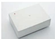
Módulo direccionable de **zona convencional**. Conexión directa al bucle, alimentación del mismo **y aislador de cortocircuitos incorporado**. Permite controlar una zona con uno o varios detectores convencionales asignándoles una dirección colectiva en la central. Led indicador de estado. Medidas: 154 x 109 x 50 mm.
