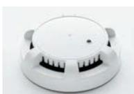
Detector **multisensor óptico – térmico** de tecnología analógica y direccionamiento individual. Combina las características de los detectores de humo y temperatura para ampliar el espectro de detección. Control de sensibilidad y corrección de contaminación desde la central. Led indicador de estado y salida para piloto remoto. Diámetro: 100 mm. Certificado EN54-5 y 7. **Base no incluida.**
