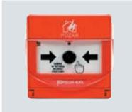
Pulsador de alarma para interior direccionable con **aislador de cortocircuitos incorporado**. Disparo manual **rearmable**. Incluye tapa transparente de protección y led indicador de estado. Medidas: 102 x 98 x 46 mm. Certificado EN54-11.
